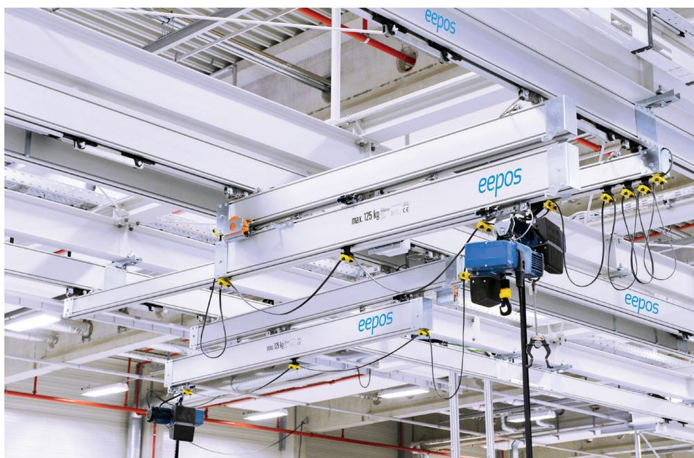
Teleskopierbare eepos Aluminiumkrane an der Fendt Hauptmontage
