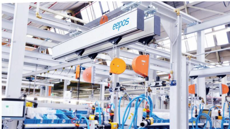
eepos Profile mit Fahrwerk in der Fendt Traktorenvormontage
