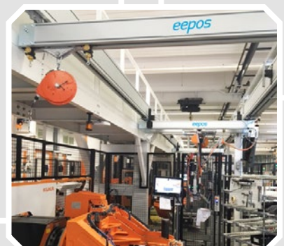
Station 2: Schrauberzelle mit eepos Kränen
