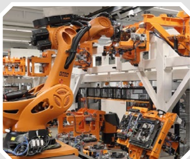
Station 1: Der KUKA Titan entnimmt ein Grundgestell aus der Spannvorrichtung
