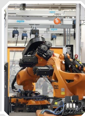
Übergabe der Achse 1-Baugruppe an die Station 2 "Schrauberzelle"
